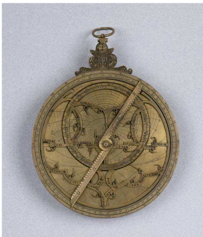
Face de l'astrolabe comportant l'araignée
